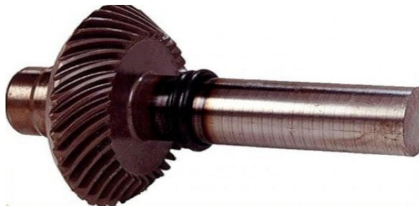
Figure 1.8 : Engrenage soudé par friction [10].
