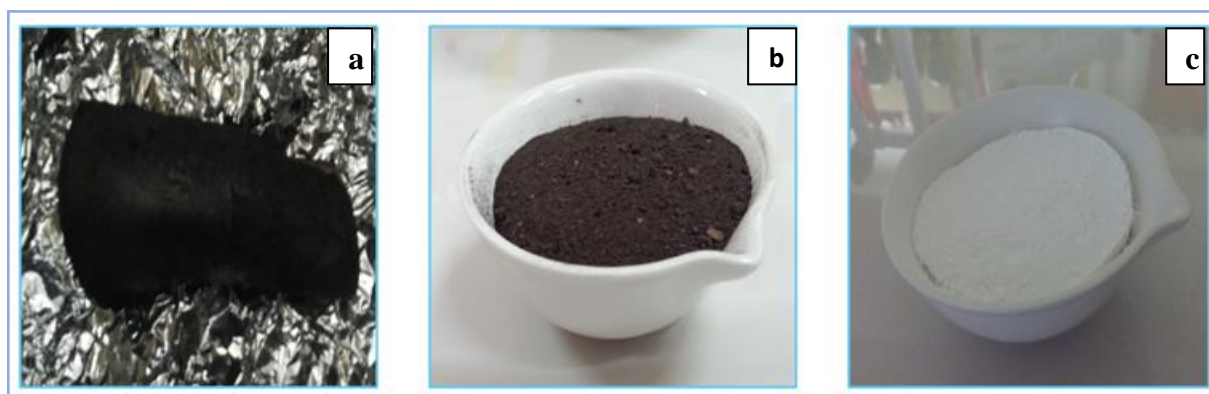
Figure IV.21 : Variation de la couleur des cendres après calcination de l'os dromadaire à 600°C pendant 12h (a. après traitement par chalumeau, b. Après broyage, c. Après calcination).
