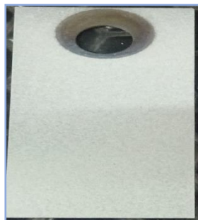
Figure IV.37 : photographie de revêtement d'hydroxyapatite préparé à partir de l'os dromadaire.
