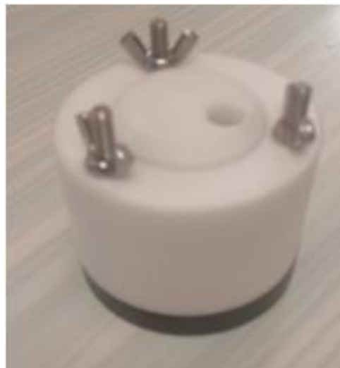
Figure 20: Photo de la cellule électrochimique expérimentale fabriquée au laboratoire utilisé avec le Bukypaper comme une électrode de travail.
