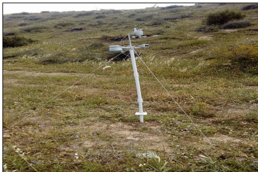
Figure 09 : Installation de la station météorologique Wireless Weather au niveau d’une station étudiée pour la mesure des données météorologiques
