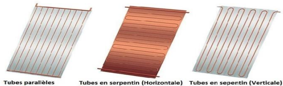
Figure III.6 : Les différentes configurations du circuit hydraulique [32]
