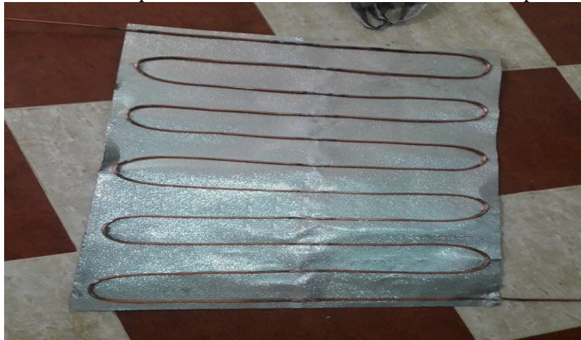
Figure III.9: Une serpentine soudée avec un absorbeur
