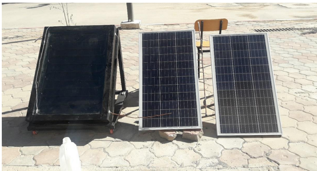
Figure IV.1 : Les panneaux solaires et le capteur thermique pendant les essais
