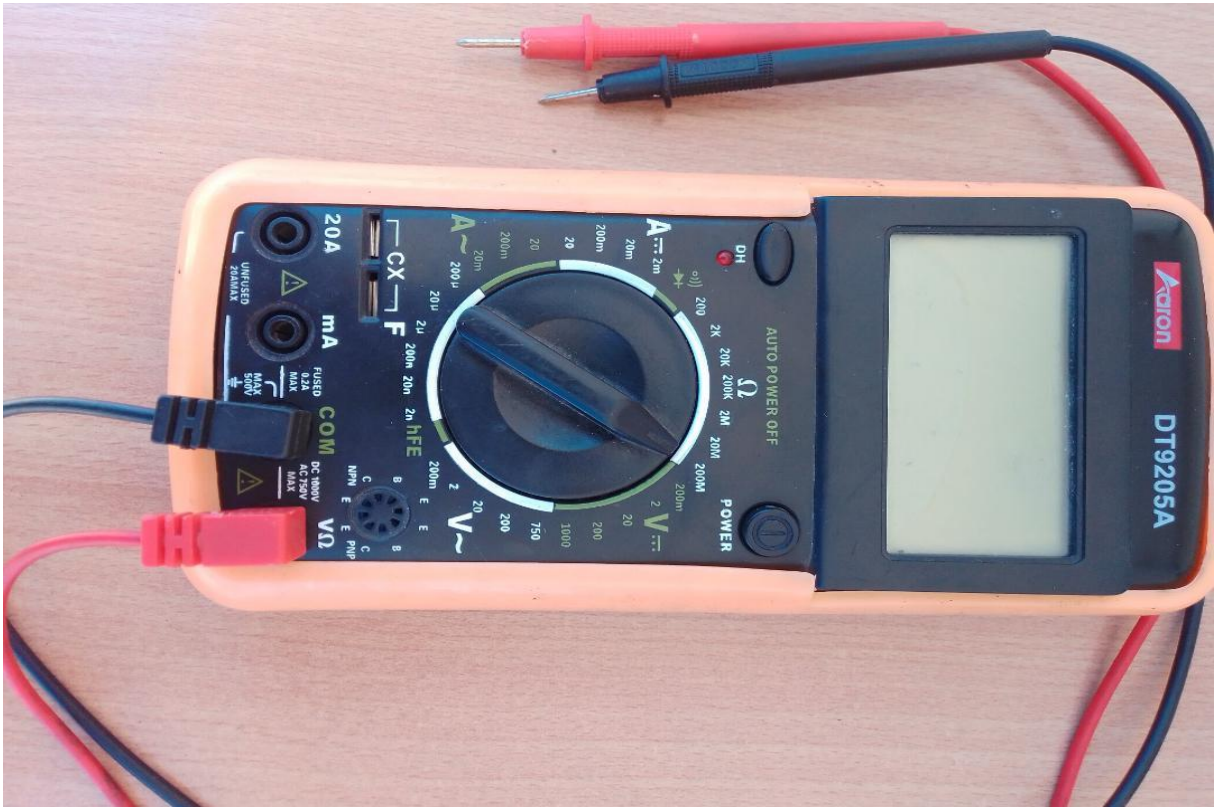
Figure III.18: Multimètres pour la mesure de courant
