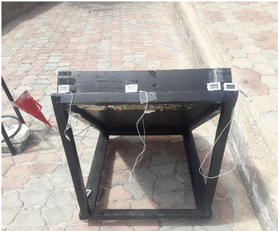
Figure III.21: Sondes de températures installées dans un capteur solaire
