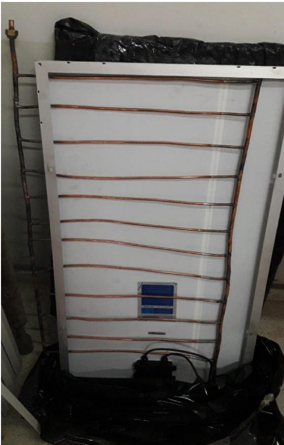
Figure III.15: Panneau solaire refroidi PV/T
