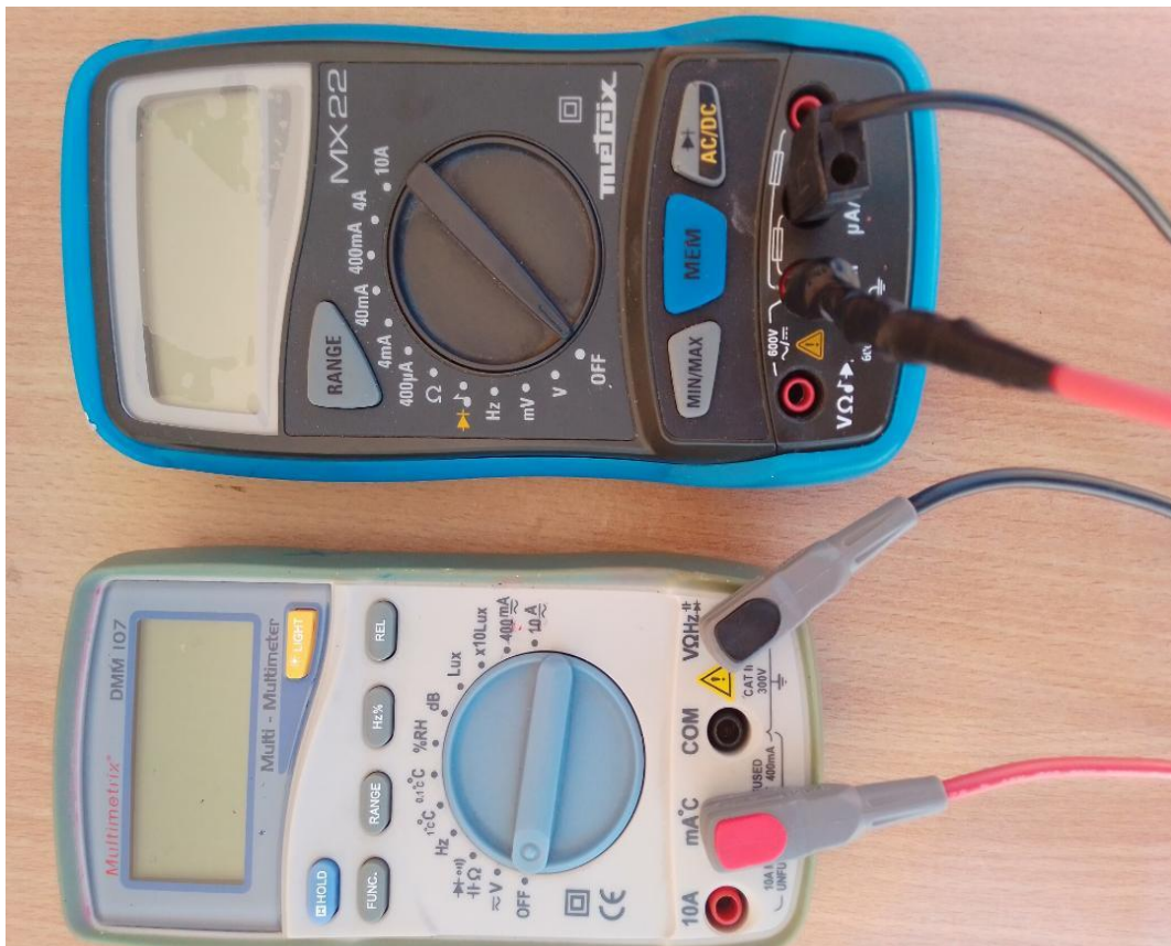
Figure III.19 : Deux Multimètres pour la mesure de tension.
