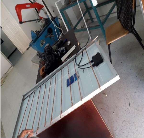
Figure III.14: Panneau solaire refroidi PV/T réel et en dessin en perspective cavalière
