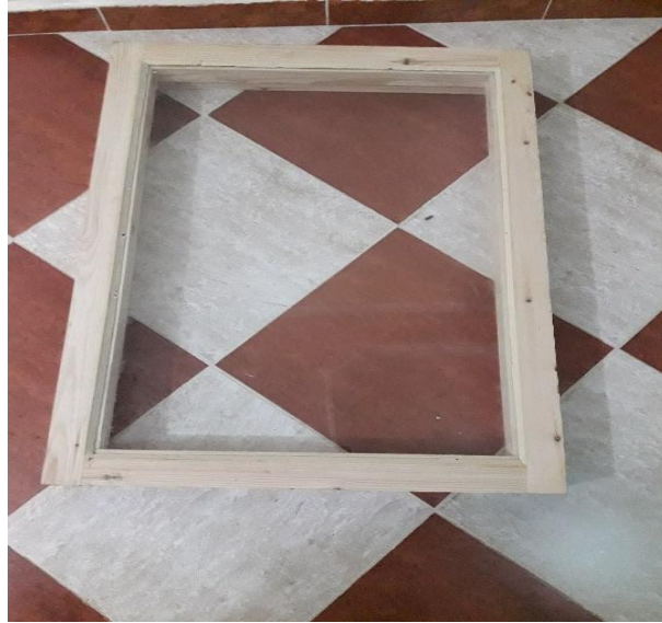
Figure III.4: La cadre de capteur solaire en bois.
