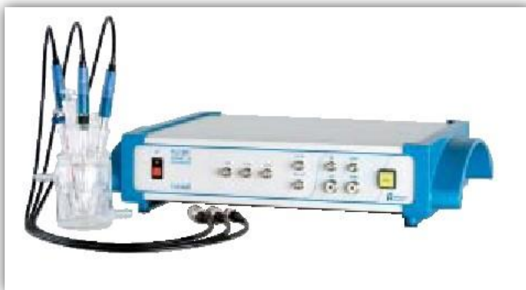
Figure II.2 : Dispositif expérimental (la cellule et le Voltalab).
