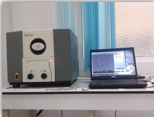
Figure II.10 : Représentation d'un microscope électronique à balayage de type JCM-5000.
