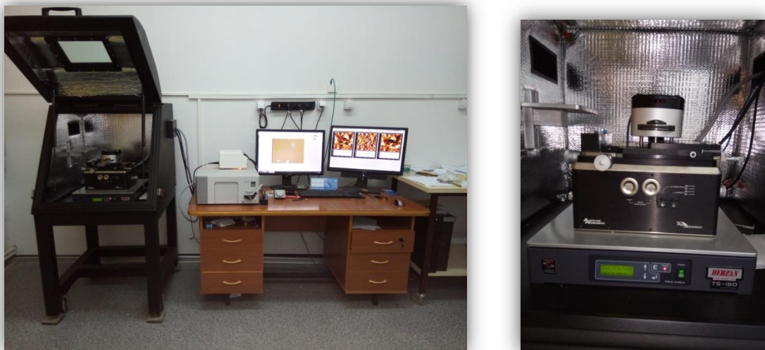
Figure II.7 : Représentation d'un microscope à force atomique AFM de type MFP-3D Classique.
