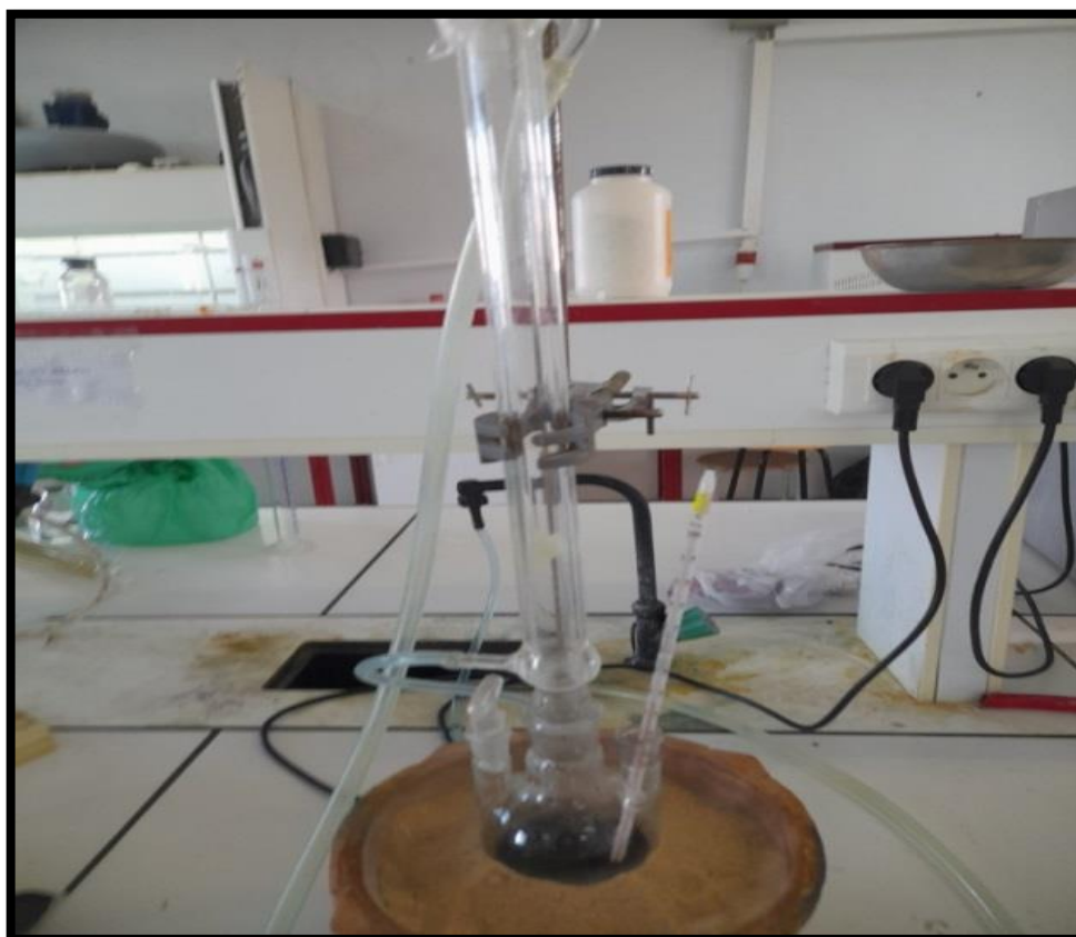
Figure II.6 : Montage opératoire de la réaction de polymérisation en solution (PVA-PANi).
