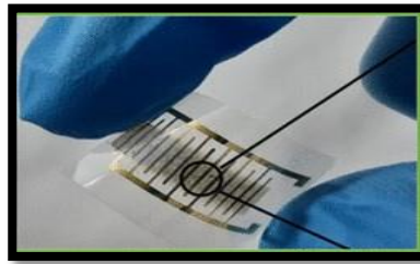
Figure I.20 : Image d'un capteur d'humidité résistif.
