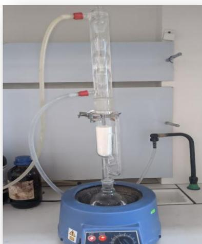
Figure II.5 : Montage d'extraction de Soxhlet
