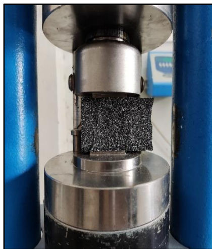
Fig . 11 Essai de compression
