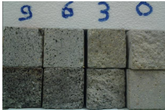
Figure.I.23. Vue des demi-spécimens exposés aux quatre cycles de chauffage-refroidissement à la ambiants (20°C) et à la température 400°C [22].
