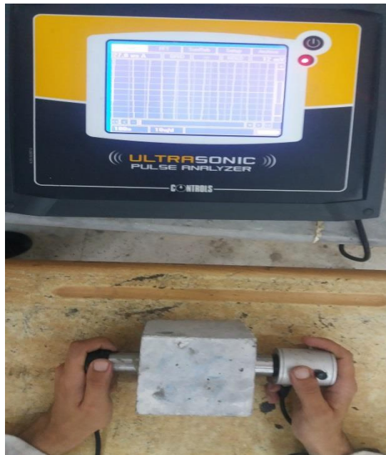
Figure II.14 : Appareillage pour l'essai ultrasonique.
