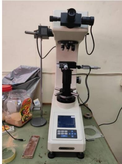
**Figure 3. 8:**la machine utilisé dans l'essaie d'indentation.
