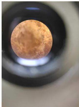
**Figure 3. 10 :** Empreinte obtenue après essai d'indentation.
