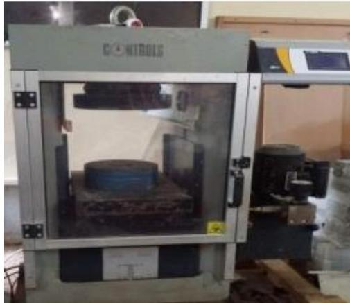
**Figure 1. 7:**Mesure de la résistance à la compression.
