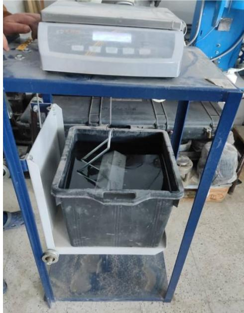
**Figure 3. 7: Pesée hydrostatique.**
