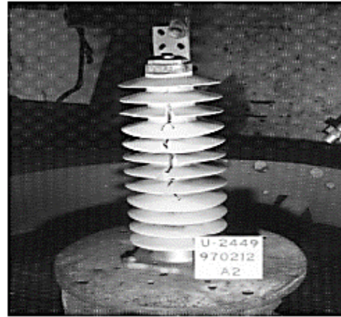
Figure. 15. Le même parafoudre après un essai de court-circuit.
