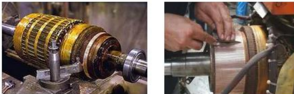
Figure 3.4 : L'induit de la MCC.
