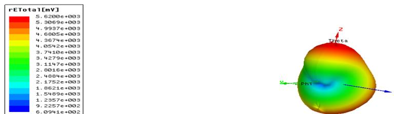
Figure III.13: Diagramme de rayonnement de l'antenne en 3D
