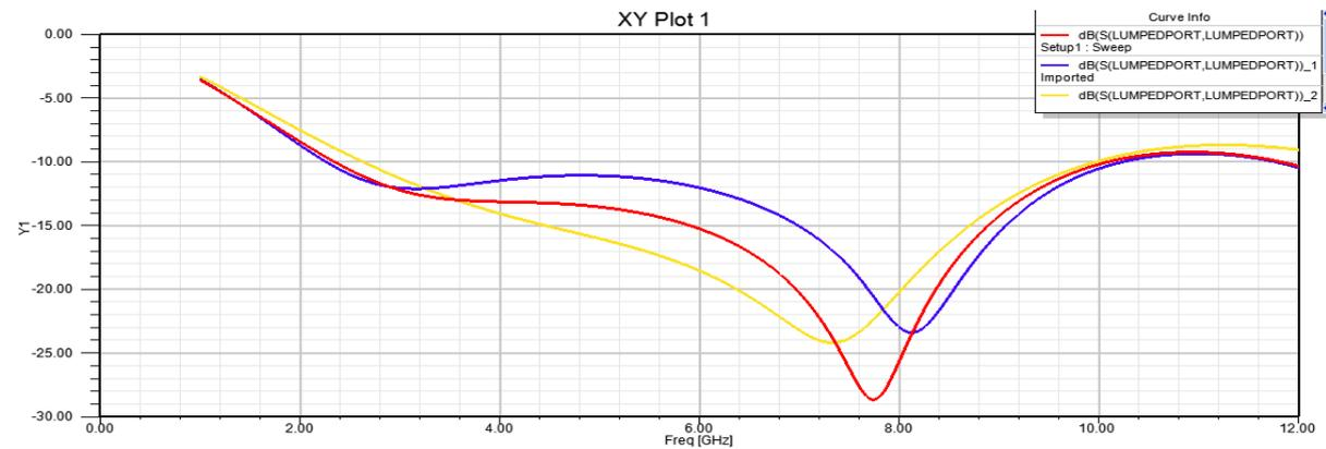
**Figure III.6:** Variation du coefficient de réflexion  $S_{11}$ , pour différentes valeurs de  $h$ .
