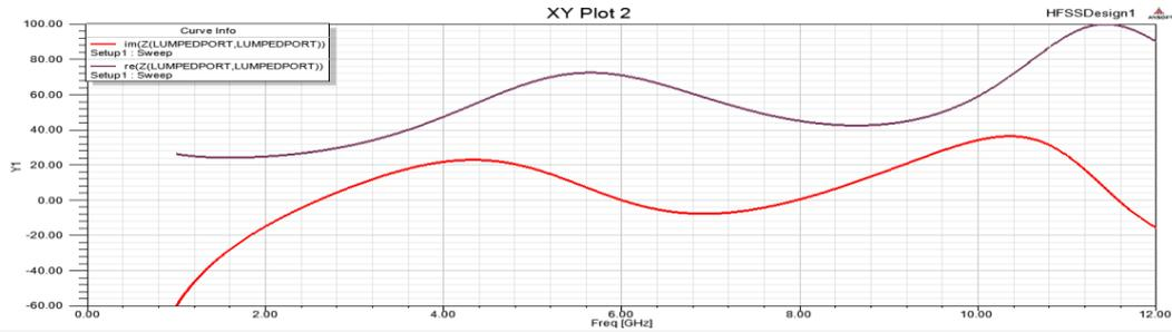
Figure III.11: Paramètres Z de l'antenne simulée en fonction de la fréquence
