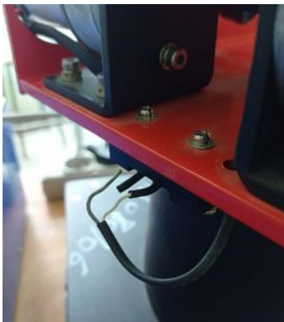
Figure 23 Fil coupé du limite switch
