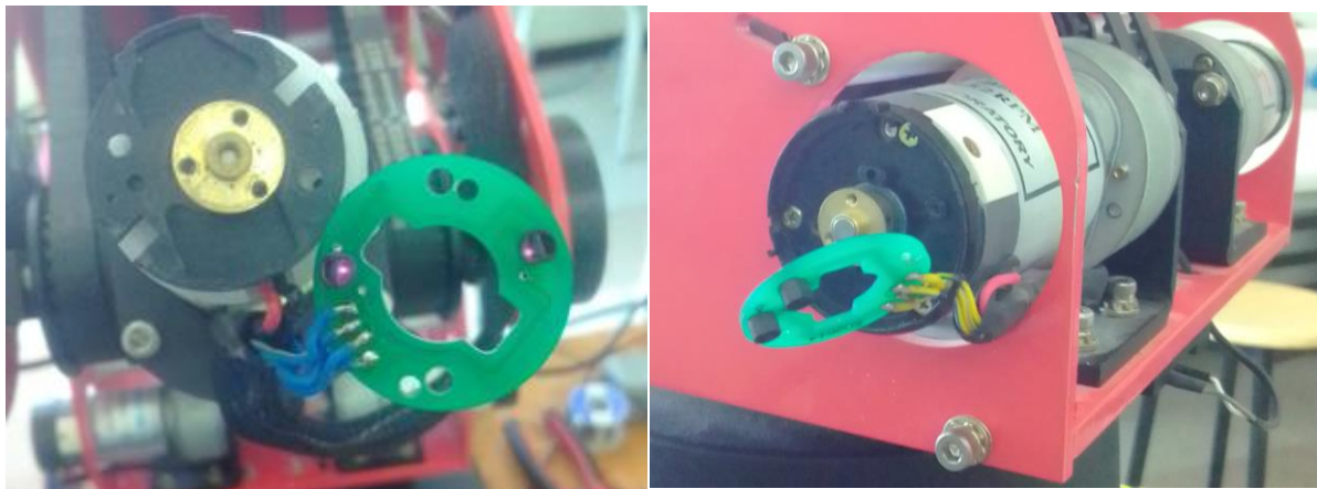
Figure 21. Changement du phototransistor de A à C
