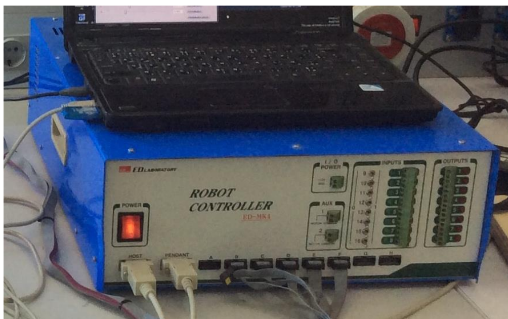
Figure 17. L'unité de contrôle ED-MK4
