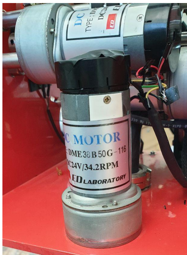
Figure 16. Moteur du robot ED-7220c
