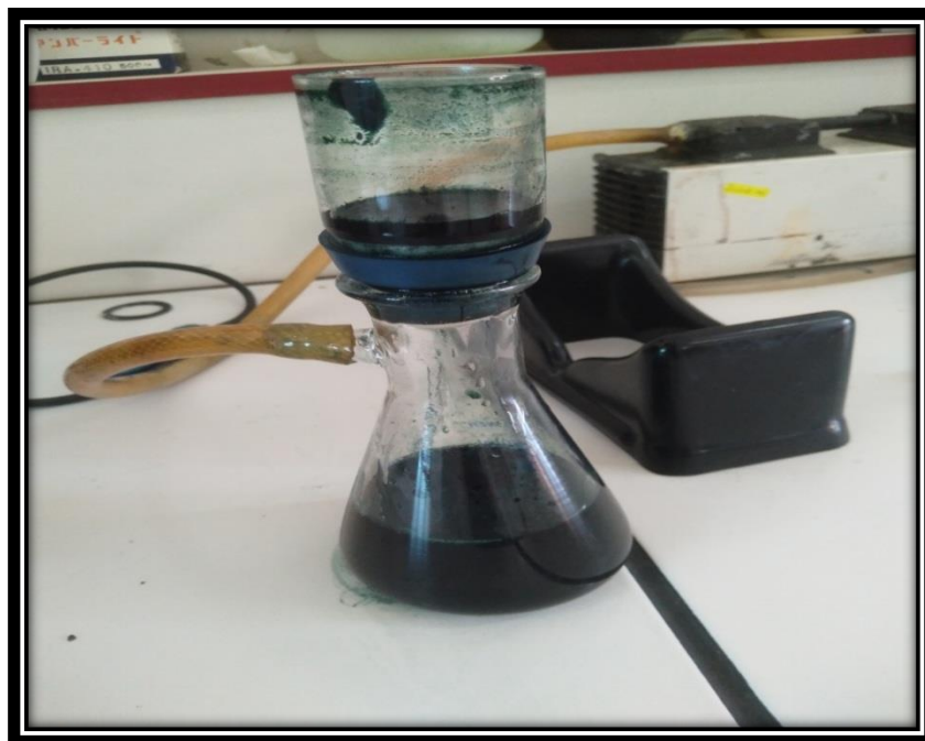
Figure II.4 : Montage de filtration sous vide.
