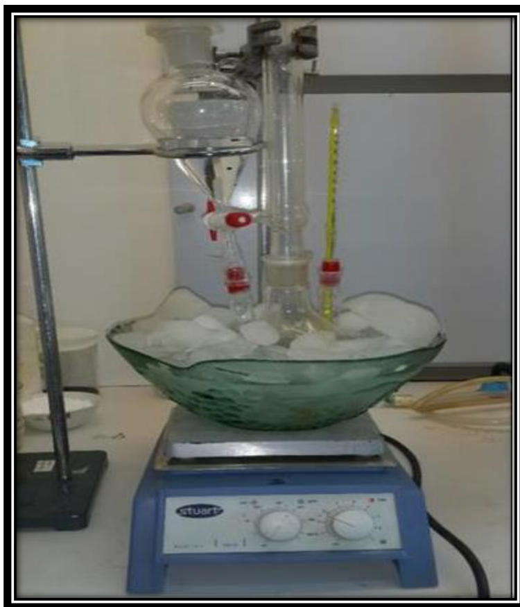
Figure II.3 : Montage réactionnel de la synthèse de la Polyaniline.
