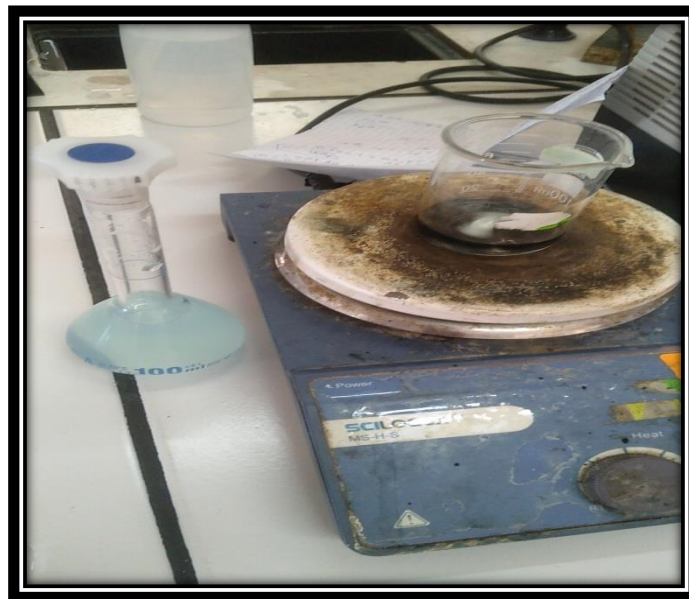
Figure II.10 : Solution de chlorure de cuivre en contact de polyaniline.
