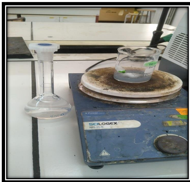
Figure II.8 : Solution de Nitrate d'argent en contact de polyaniline.
