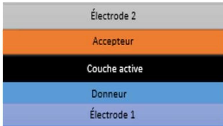
Figure 2.9 : Configuration multicouche [46]
