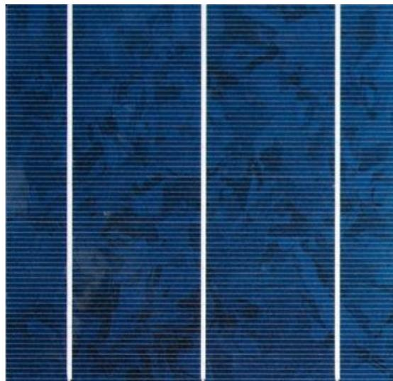
*Figure 2.4 : Cellules polycristallines [39]*
