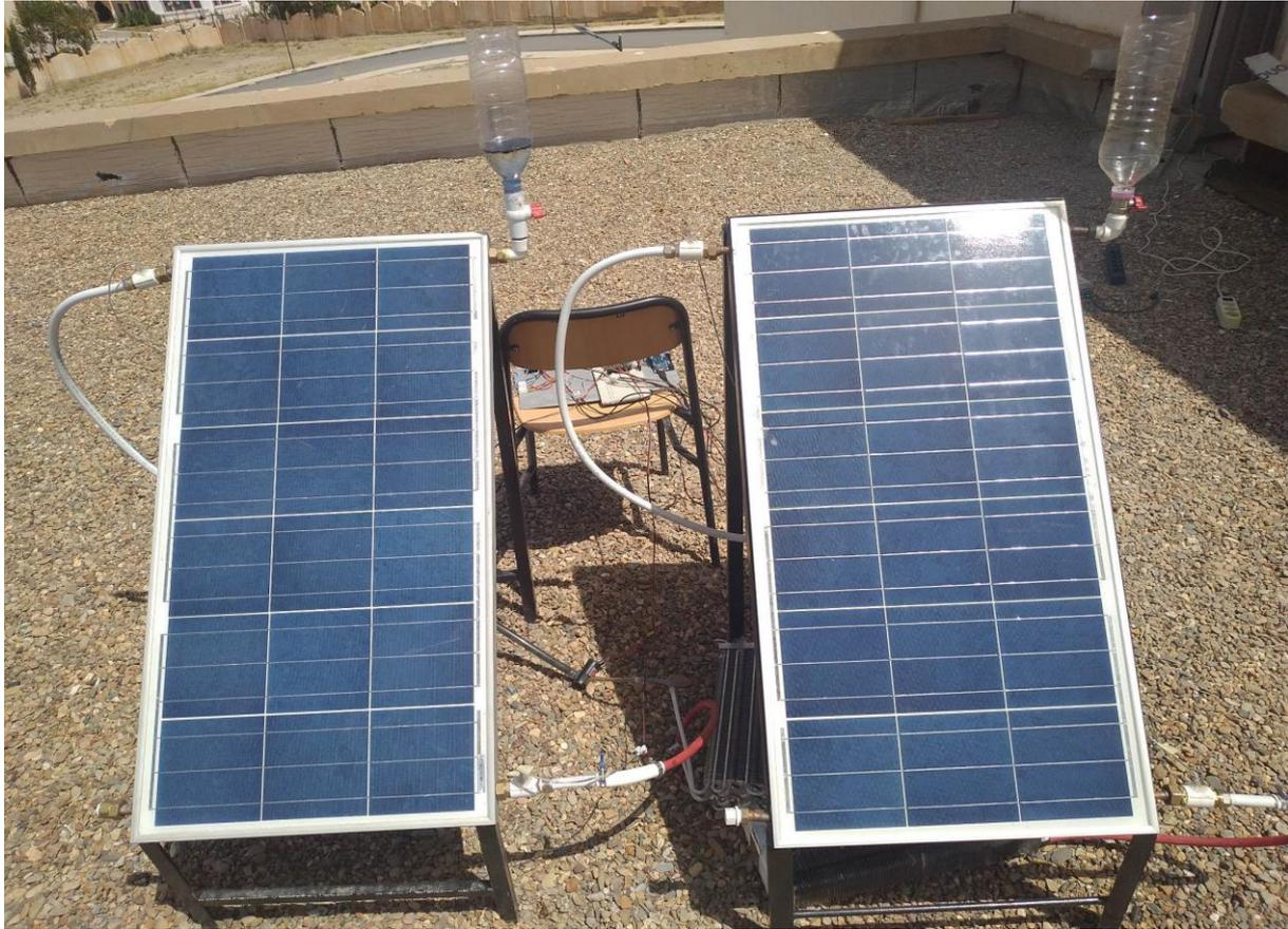
*Figure 3.26 : Système hybride ( PV / T )*
