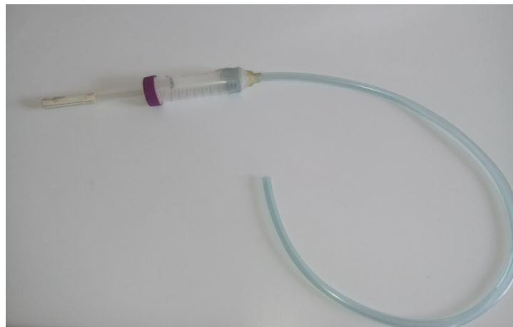
Figure 17. Aspirateur à bouche utilisé pour capturer les adultes après leur émergence(Cliché Benmenni & Haddad, 2018).
