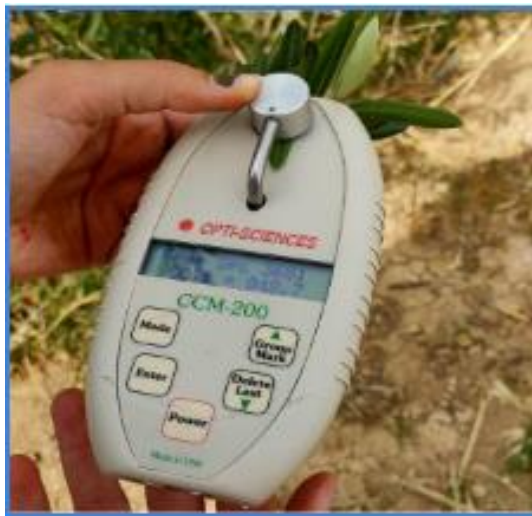
Photo 07: L'appareil de Chlorophylle Mètre.
