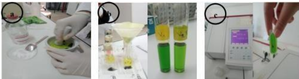
- Figure 2 : Etapes à suivre pour le dosage des pigments chlorophylliens (a: Broyage des feuilles, b: Filtration de la chlorophylle, c: Lecture par spectrophotomètre).
