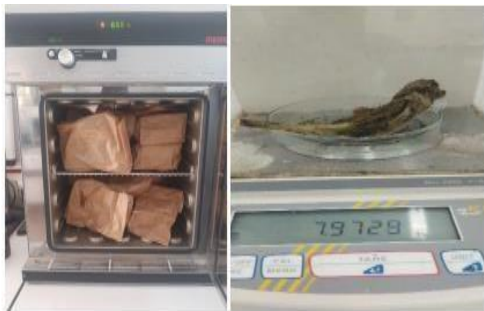
Figure 8 : Étuve réglé à 70° pour sécher les échantillons (Photo personnelle).
