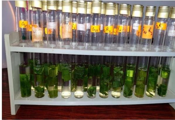
**Photo 2 :** Des échantillons de feuilles placées dans des tubes à essai remplis de 10 ml d'eau distillée le taux de dommage cellulaire causées par le stress thermique.
