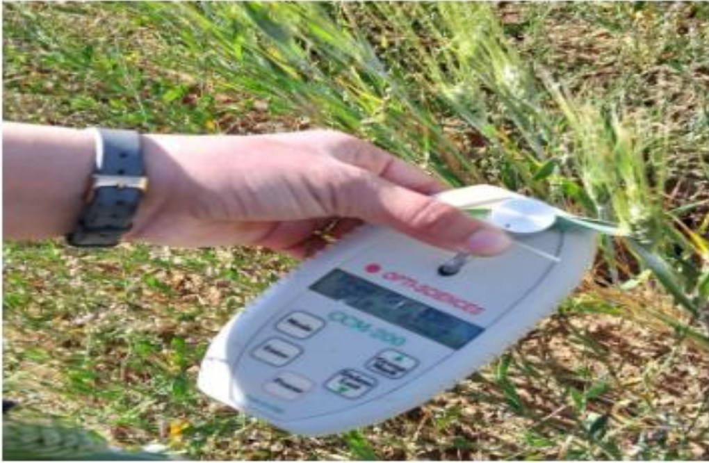
Photo 01 : Mesure de la teneur en chlorophylle des feuilles en utilisant le chlorophylle-mètre type CCM-200.
