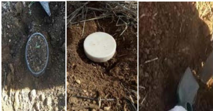
Figure 06 : Méthode de prélèvement du sol et de calcul de la densité apparente du sol
