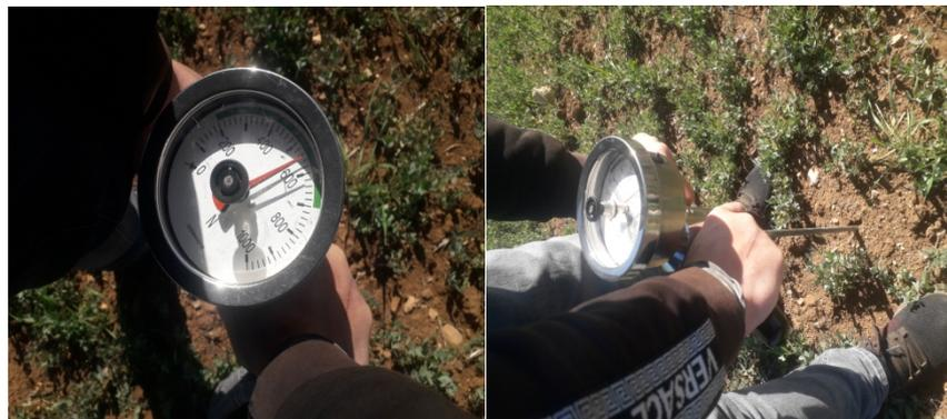
Figure 07 : Photo représentative de la mesure par pénétromètre.
