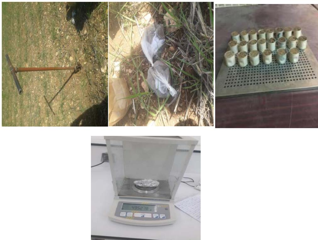
Figure 05: Mesure de l'humidité de sol
