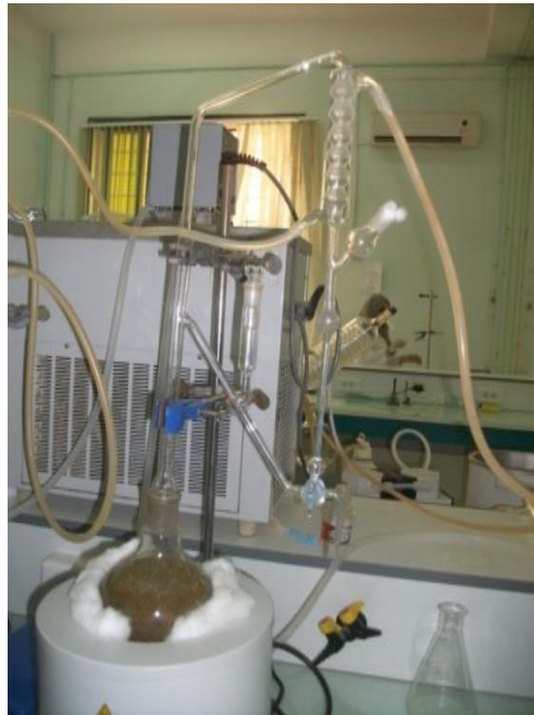
Figure 1. 4: Dispositif d'extraction des huiles essentielles par hydrodistillation.
