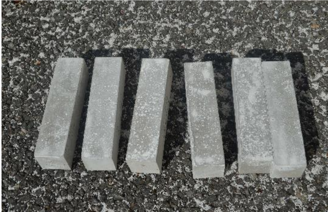
Figure 6.1 : éprouvettes 4*4*16 de fibrociment
