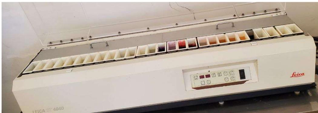
**Photo 06:** L'automate de coloration (Leica)
