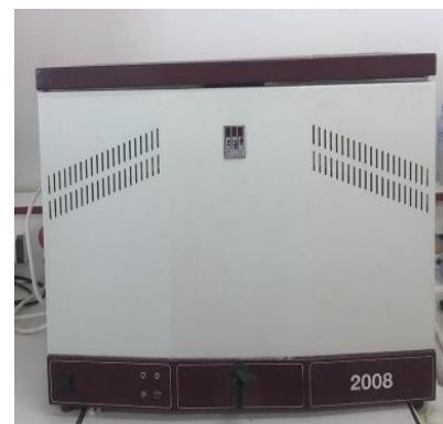
Distillateur de la marque BunchI Distillation Unit K- 350 (Switzerland).
