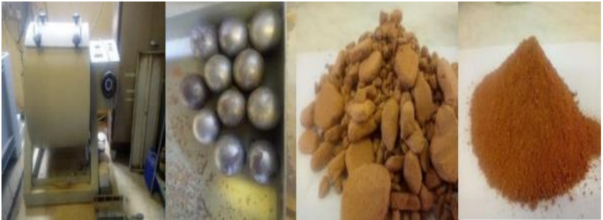
Figure II.7 : échantillon de chamotte (casse de brique)
