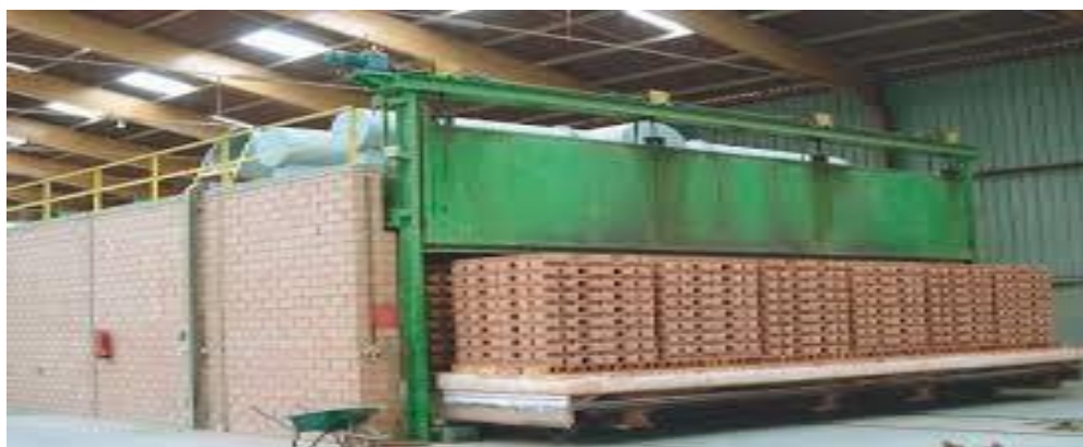
Figure II.6 : four tunnel de la ligne de production
