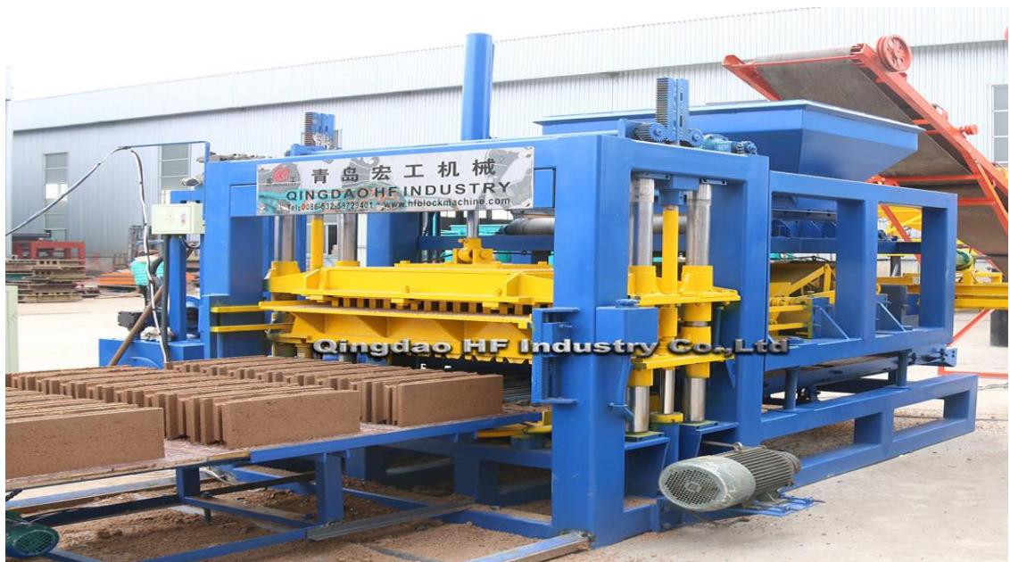
Figure II.4 : Mouleuse sous vide
