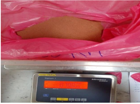
Figure III.5: Déchet de brique rouge broyé
