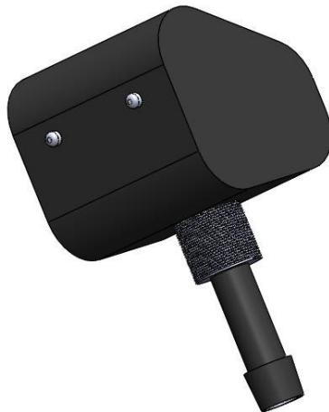
Figure 3.12: buse d'injection d'eau sur SolidWorks
