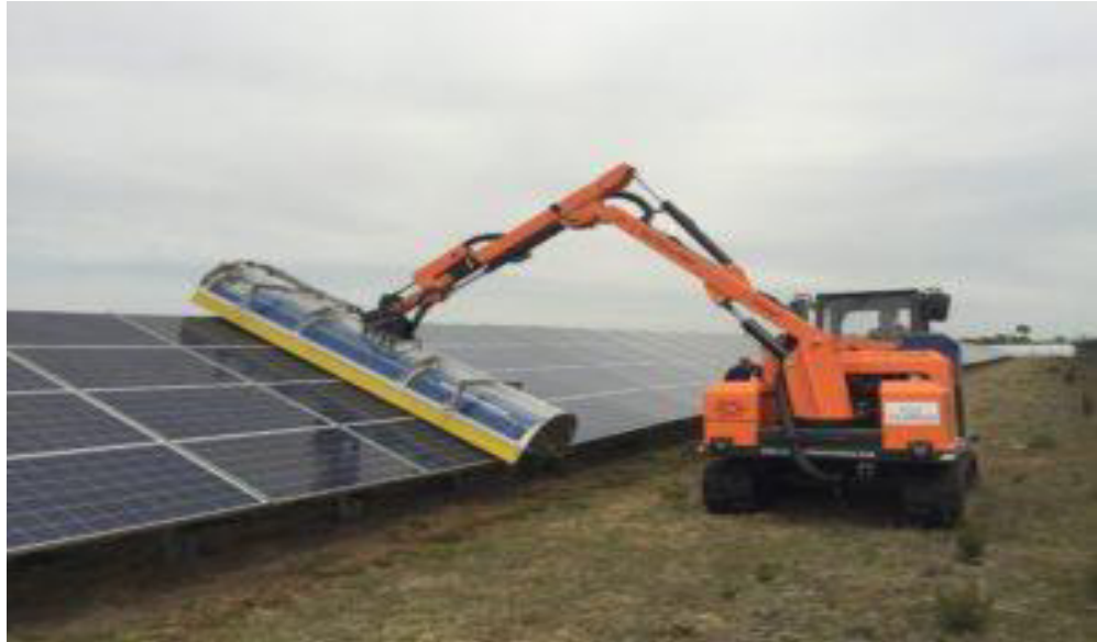
Figure 2.6: Un camion avec une flèche pour nettoyer les panneaux solaires photovoltaïque
