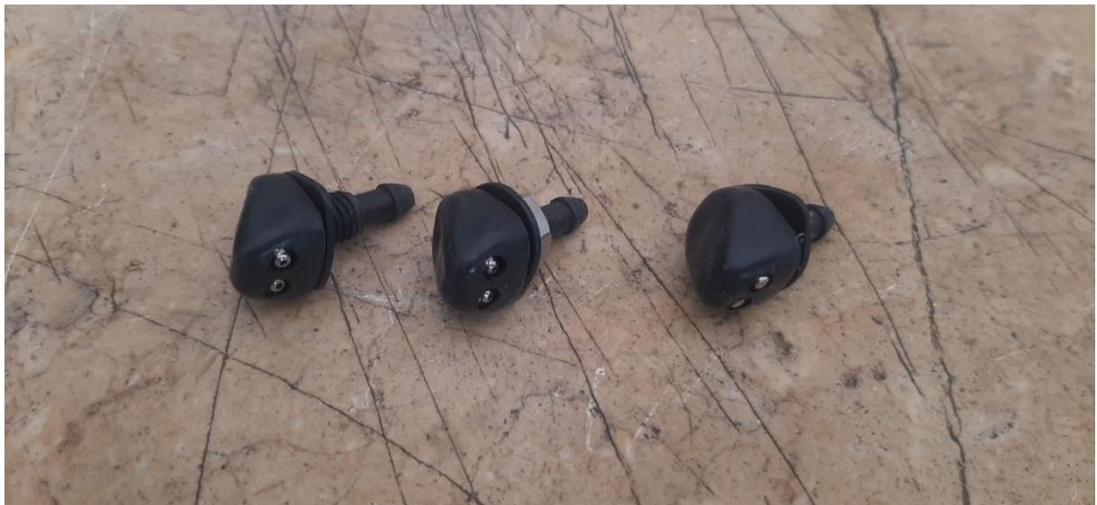
Figure 3.10 : buse d'injection d'eau
