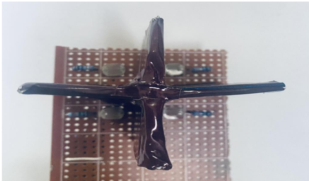
figure 2.12 Capteurs en quatre quadrants en forme(×)
