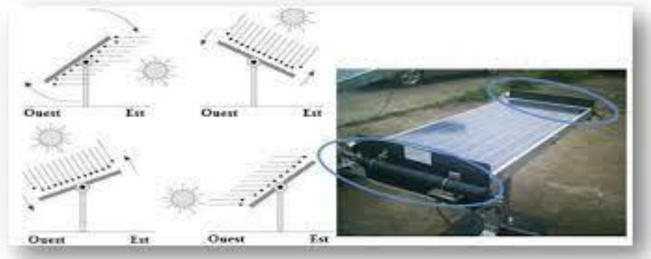
figure 2.5 Suiveur solaire passif
