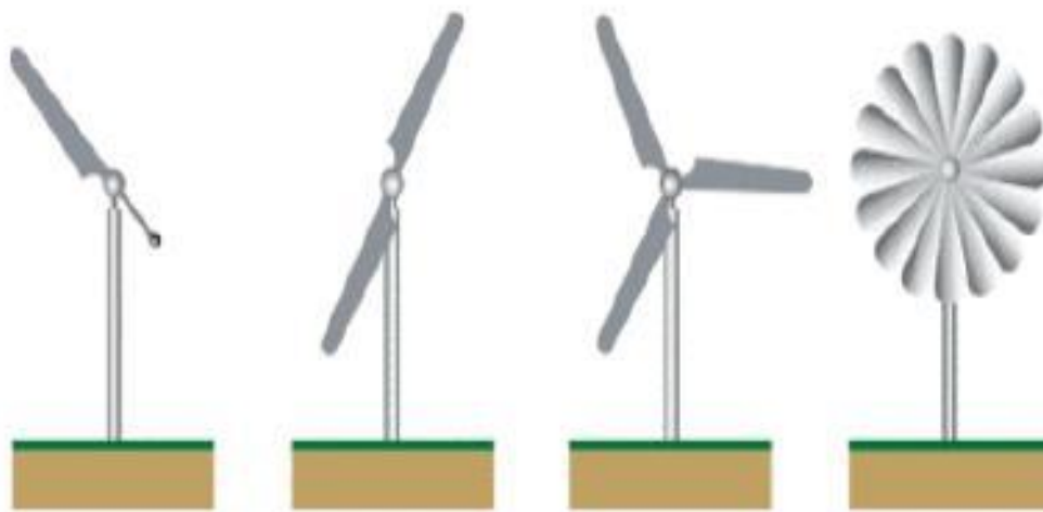
Figure 3.8 : Classification des éoliennes à axe horizontal selon le nombre de pales
