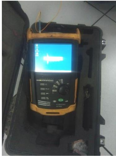
**Figure (II-14):** Réflectomètre optique portable OTDR.
