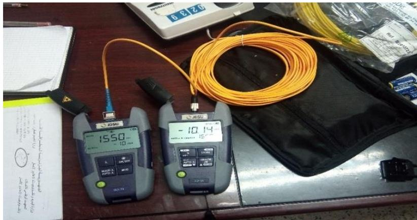
**Figure (II-13):** Mesure de l'atténuation avec les powers mètres.
