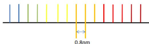
**Figure (II-2):** L'espacement des longueurs d'onde pour la technique Dense WDM.
