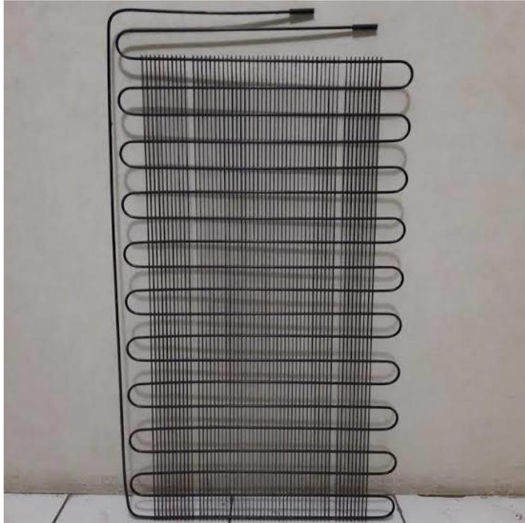
Figure III.12 : Condenseur de la machine.
