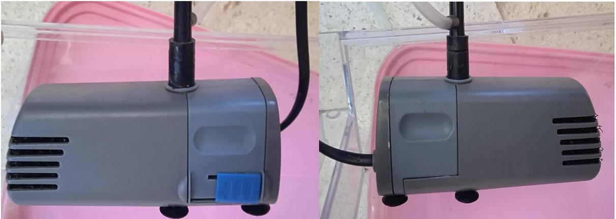
Figure III.20: Pompe centrifuge.
