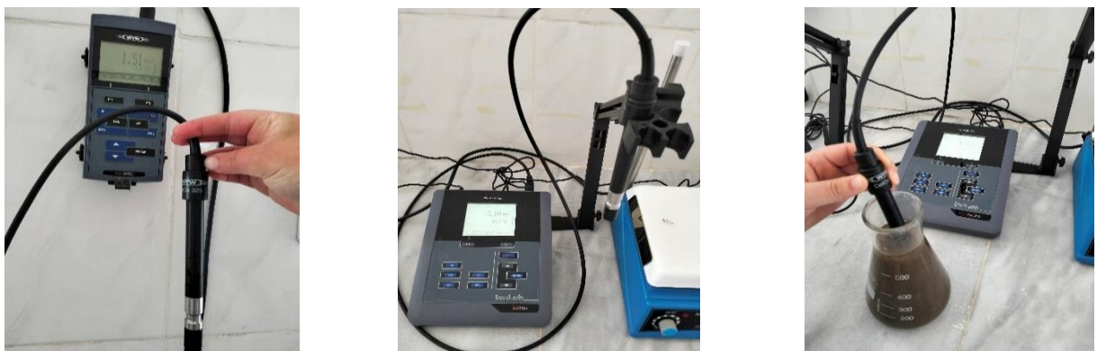
Figure 25 : Photo de l'Oxymètre portatif WTW 7310
