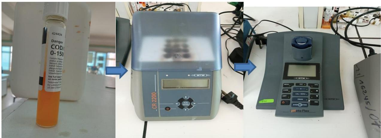
Tube DCO (0 – 1500 mg/l)      Thermoréacteur (CR 2200)      Photomètre (photo Flex)
