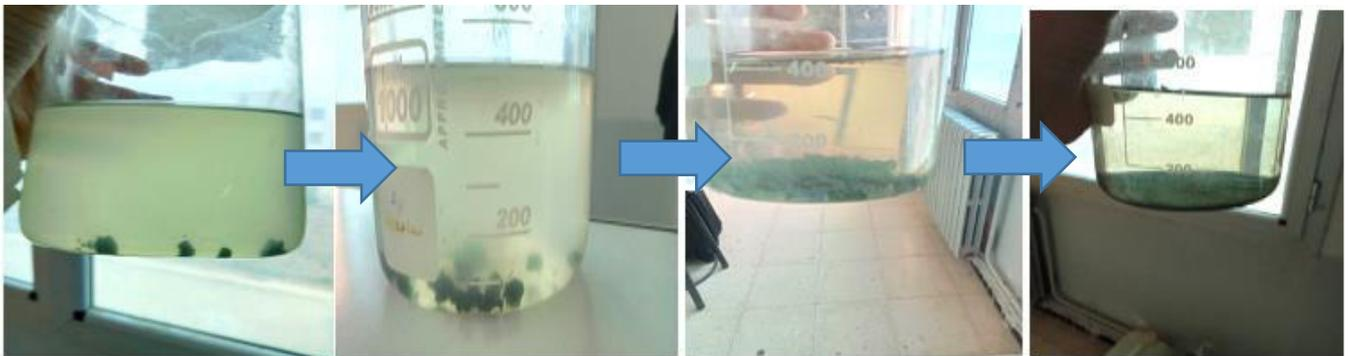
**Fig. III.15** un autre test avec de la dose optimale de coagulant  $\text{Ca}(\text{OH})_2$ .
