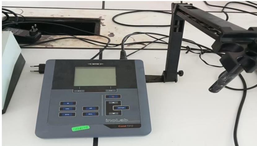
**Fig II.2 :** Conductimètre (inolab cond 7110).
