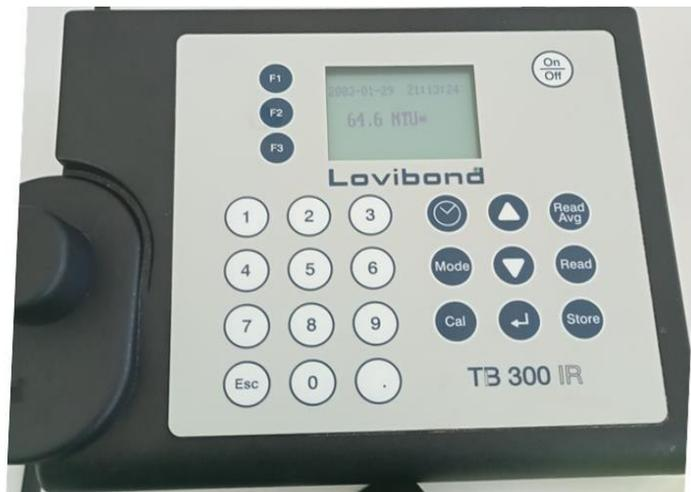
**Fig II.4 : Turbidimètre (Lovibond TB300 IR).**
