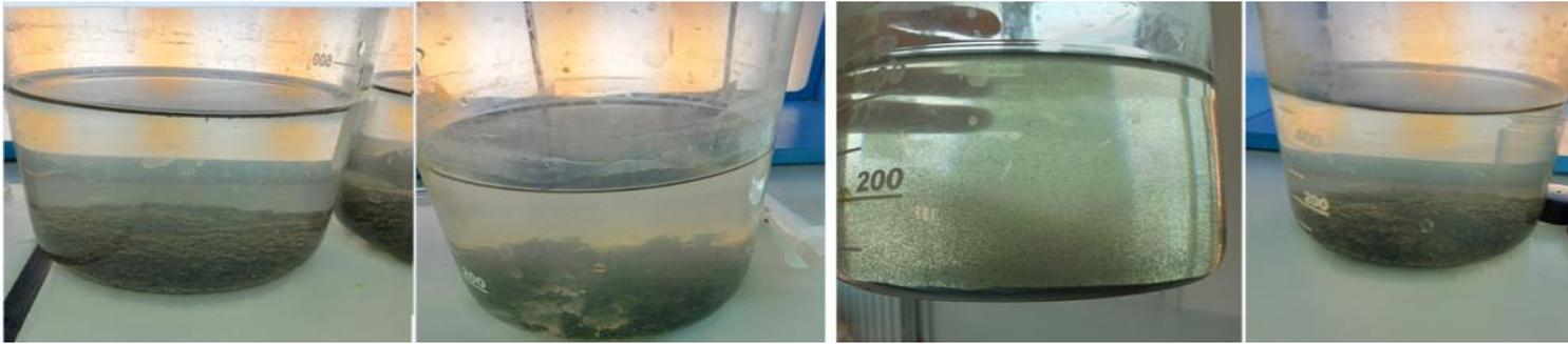
**Fig. III. 12 :** Résultats de jar test du coagulant  $\text{CaSO}_4$  saturé.
