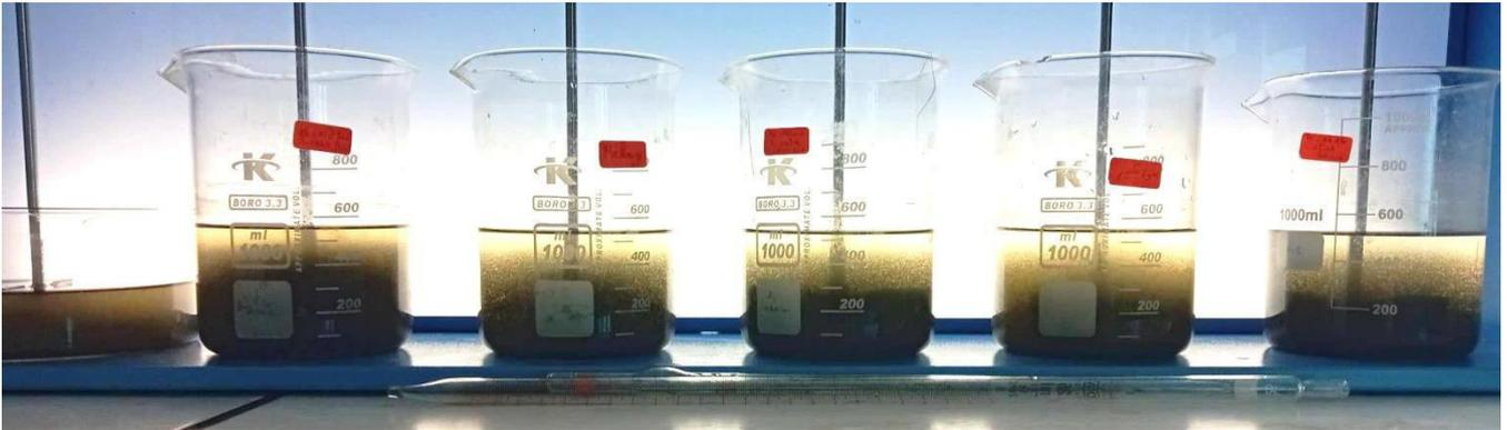
**Fig. III. 14 :** Résultats de jar test avec la chaux solide (Photo après l'arrêt de l'agitation).
