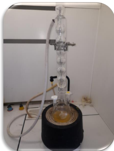
Figure 13 Montage de chauffage à reflux
