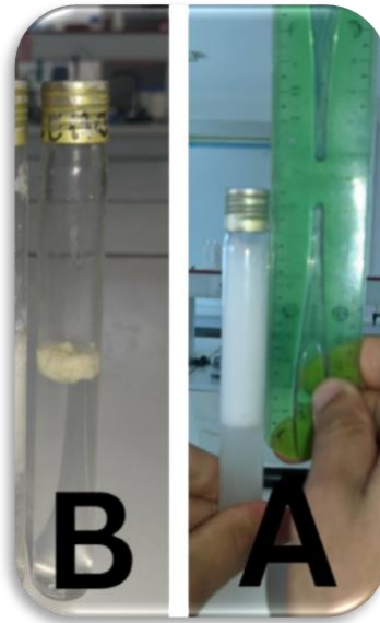
Figure 24 Photos du test pouvoir moussant en milieu acide
