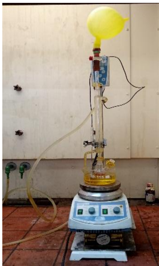
Figure II.1. Montage à reflux utilisé dans la synthèse du ligand et du complexe de fer FeL correspondant.
