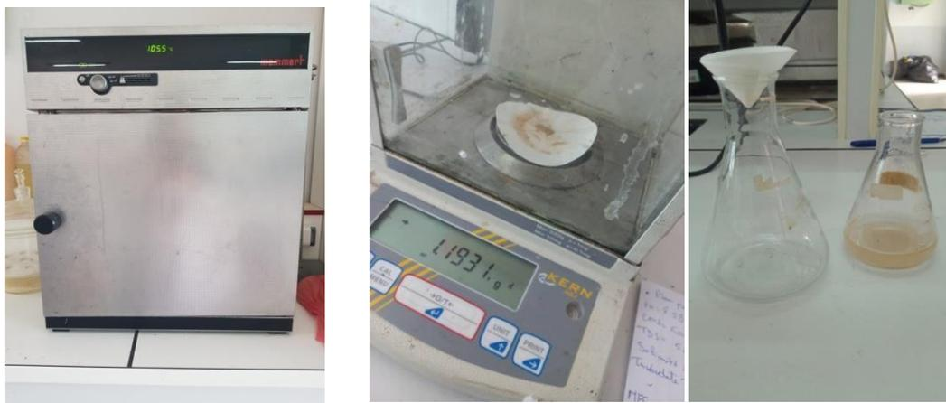
**Figure II.18** : Photos montrent les étapes de mesure de la matière en suspension.
