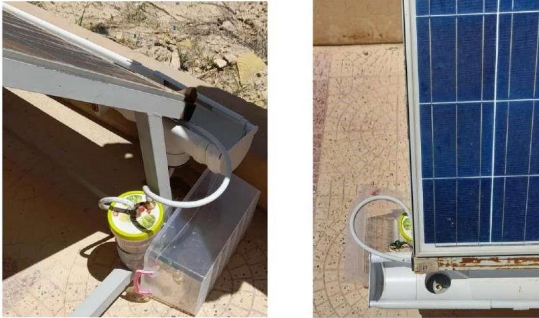
**Figure III.14 :** Photo du filtre à sable placer avec le panneau solaire.
