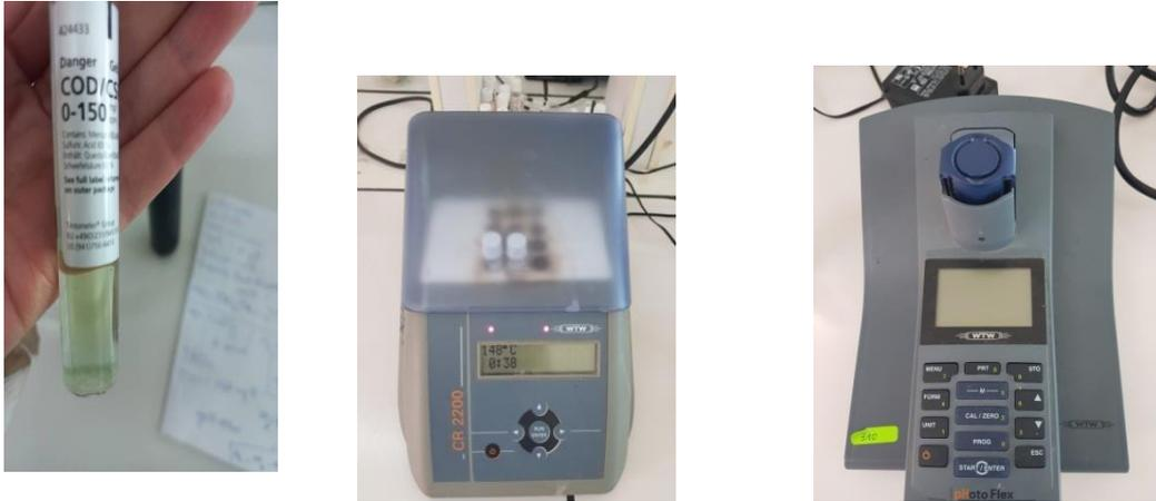
**Figure II.20 :** Mesure de la DCO (tube DCO, thermo-réacteur, photomètre).
