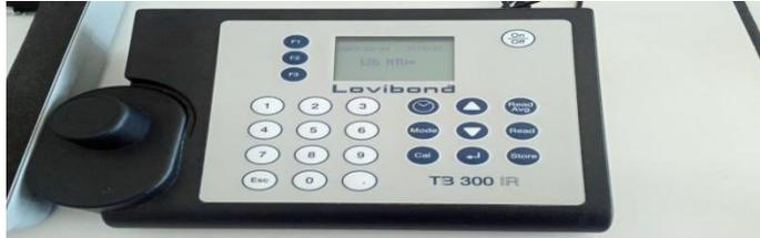
**Figure II.17 :** Turbidimètre.
