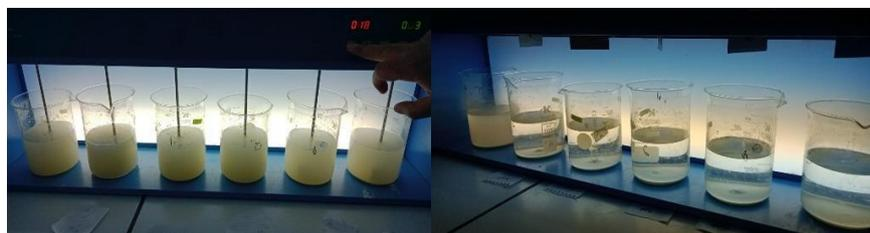
**Figure I.5 :** Coagulation et la floculation
