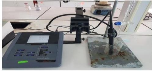
**Figure 23 :** Dosage de sulfate par la conductimétrie.
