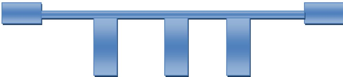
Figure.III.6 Structure d'un filtre à stub en microruban.
