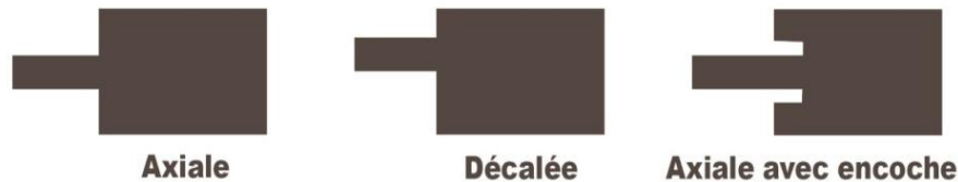
Figure I.7: Alimentation par ligne micro ruban
