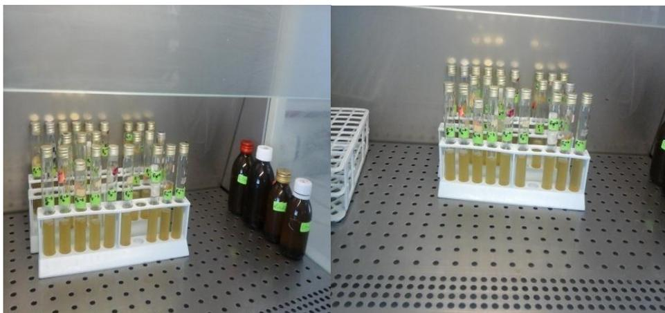
**Figure 29** Recherche et dénombrement des streptocoques fécaux.
