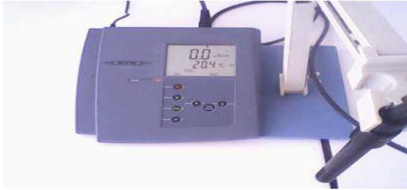
Figure 25 : Conductimètre
