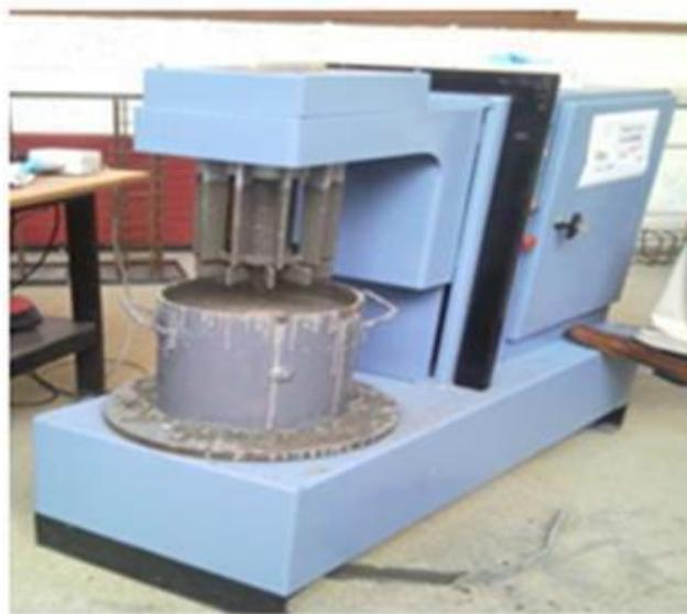
*Figure II.9 Rhéomètre BML[28]*
