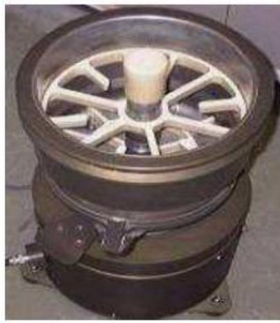
*Figure II.11 Rhéomètre à béton BT Rhéom [29].*
