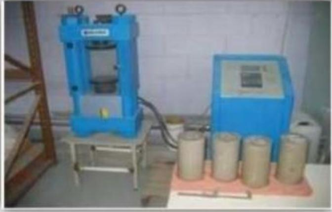
*Figure I.10 -Mesure de la résistance à la compression. [18]*
