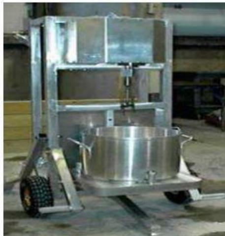
*Figure II.8 Rhéomètre à béton IBB [20].*
