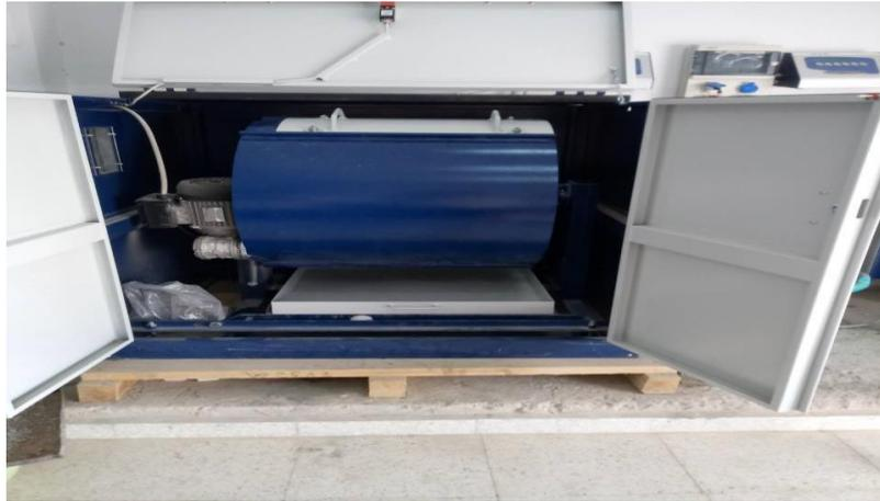
*Figure III.7: Appareil de l'essai Los Angeles*
