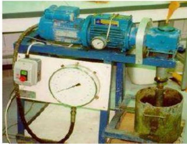
*Figure II.7 Rhéomètre Two-point-test [26].*
