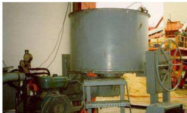
*Figure II.10 Rhéomètre à béton du Cemagref [28]*
