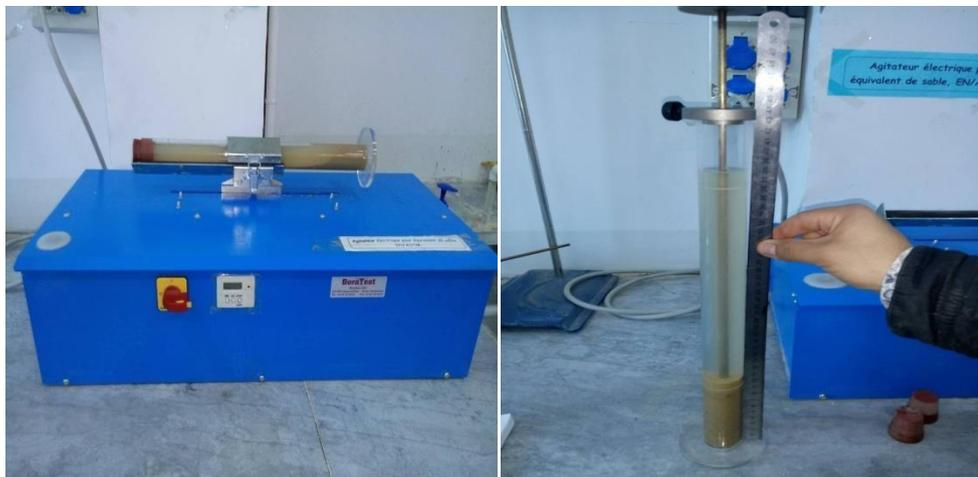
*Figure III.4 Essai équivalent de sable exécutés au laboratoire*
