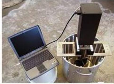
*Figure II.12 rhéomètre ICAR [29]*
