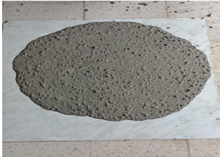
*Figure III 10 Essai d'étalement*
