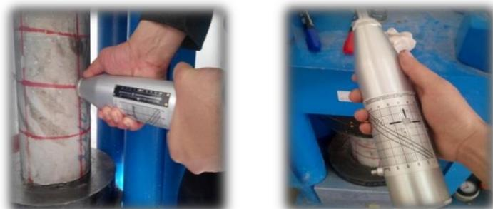
*Figure III.16 : Principe de l'essai scléromètre.*
