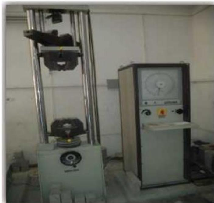
*Figure I.11 Mesure de la résistance à la traction par flexion. [18]*
