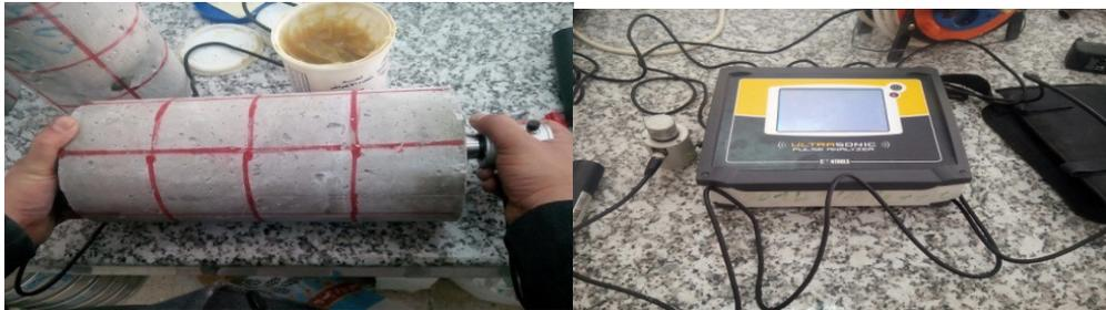
*Figure III.19 : Appareil ultrason*
