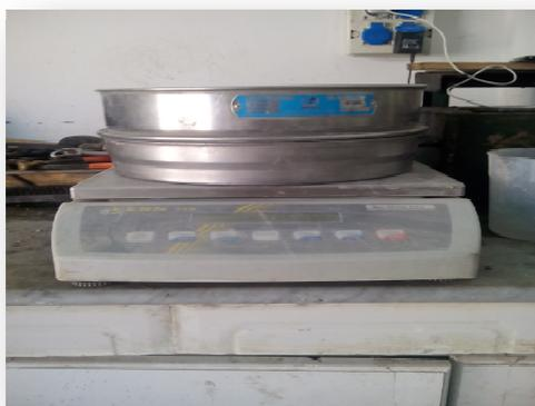
*Figure I.14. Essai de stabilité au tamis*
