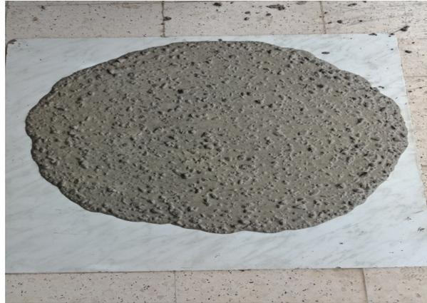
**Figure III.11 : Essai au cône d'Abrams**
