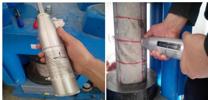
*Figure III.18 : Principe de l'essai scléromètre.*
