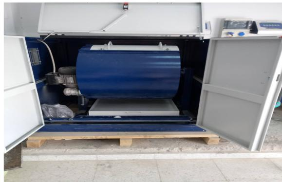
*Figure III.7: Appareil de l'essai Los Angeles*
