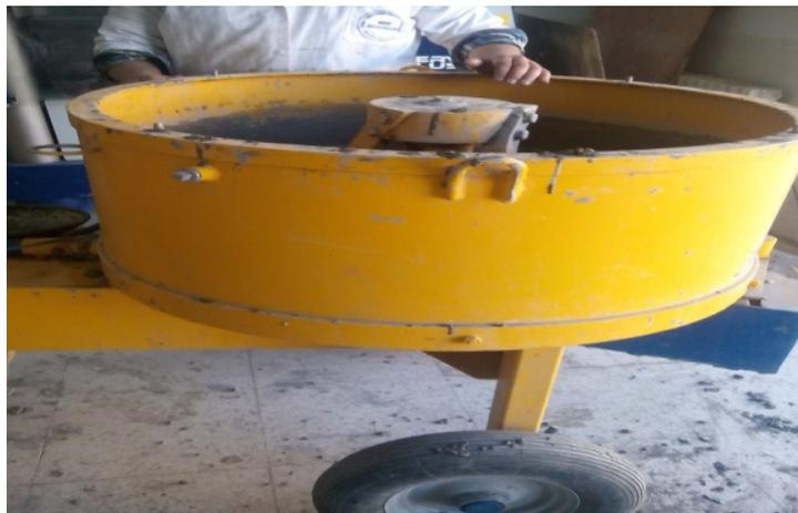
*Figure III.10 : Malaxeur à béton laboratoire de GC.*
