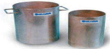
*Figure III.6 : Récipient de mesure la masse volumique (10L et 5L)*
