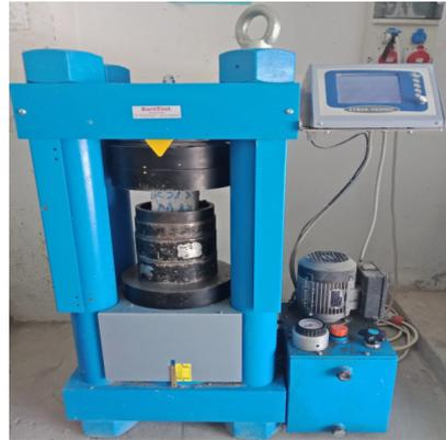
*Figure III.15 : Essai compression*
