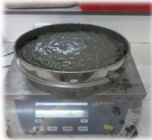
*Figure III.13 : Essai Stabilité au tamis 74xecute au laboratoire*
