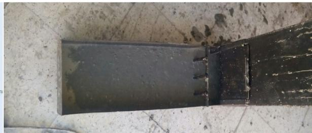
**Figure III.12 : Essai de boîte en L.**
