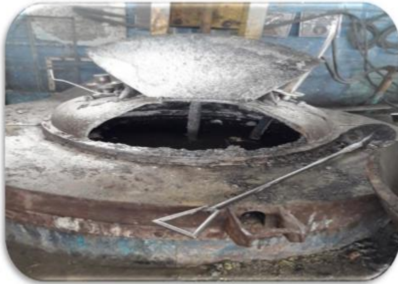
Figure I.7: Cuve d'affinage semi-sphérique munis d'agitateur à hélice.
