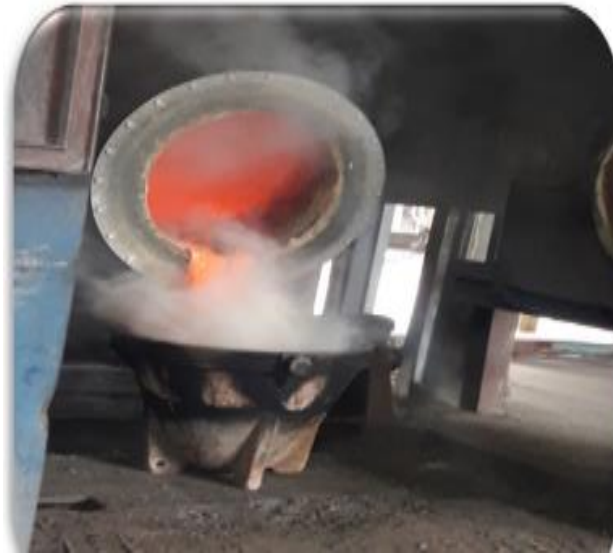
Figure I.6: Four rotatif en phase de coulée.
