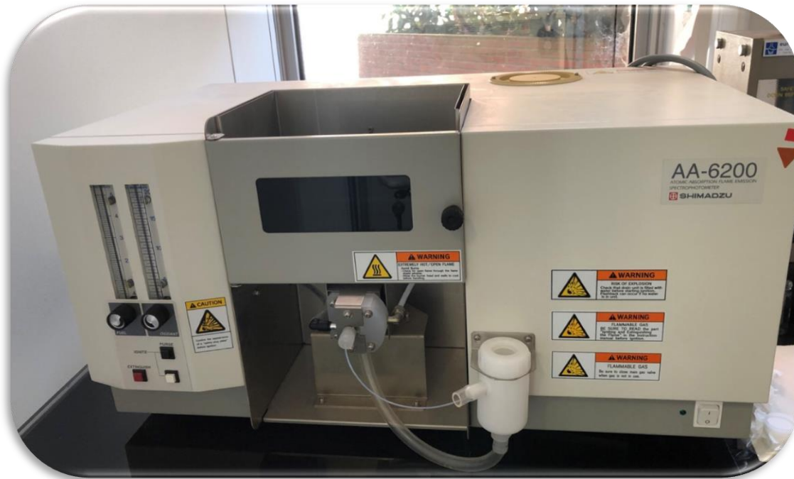
Figure III.8: Spectromètre à Absorption atomique, Shimadzu AA 6200.
