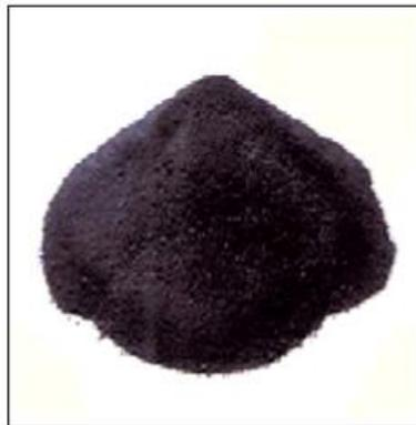
**Figure I-12:**Fumée de silice sous forme de poudre.
