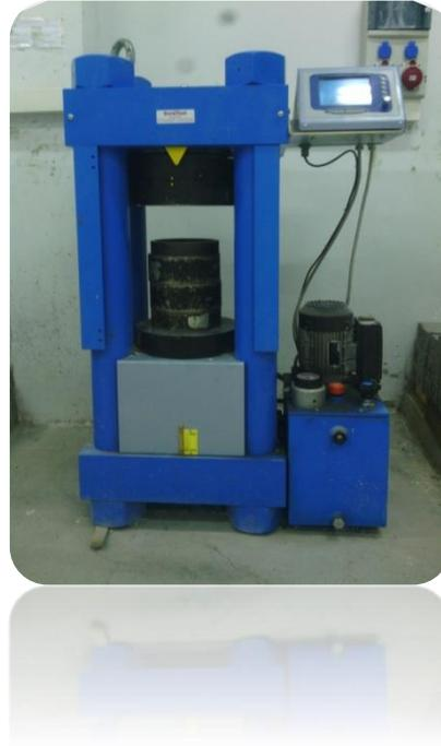
**Figure II.17 :** Presse hydraulique capacité 3000 KN
