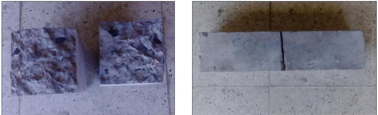
Figure III.13: rupture des éprouvettes « essais de flexion »
