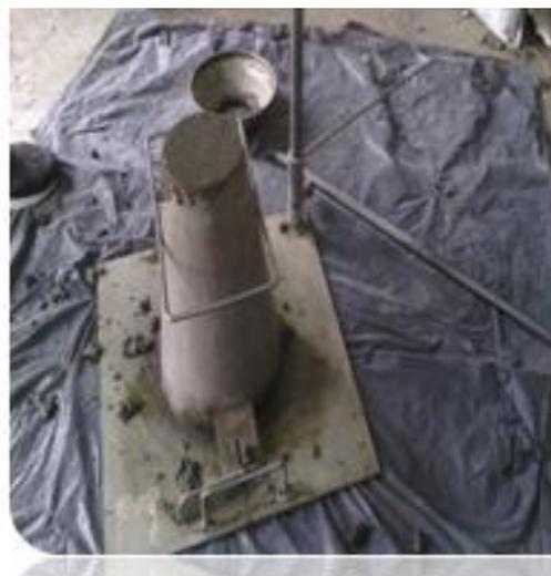
**Figure II.11** : Affaissement au cône d'abrams
