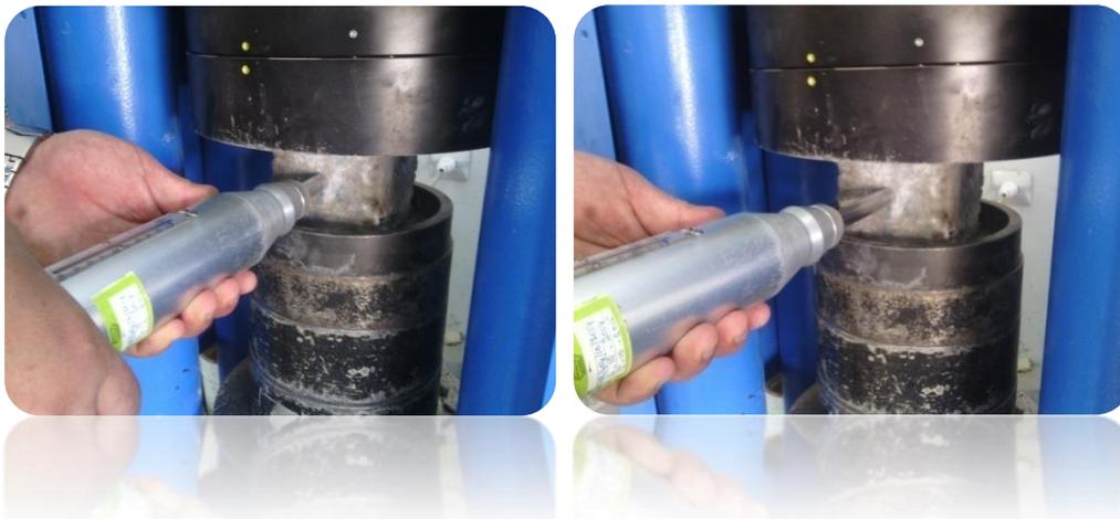
**Figure II.15 : Mesurer la dureté superficielle du béton**
