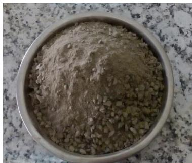
**Figure II.4 :** Le sable de démolition de béton utilisé.
