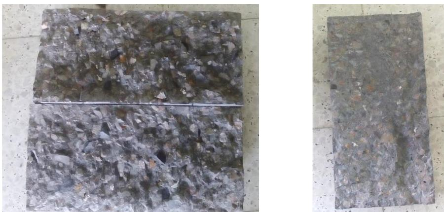
**Figure III.17:** rupture des éprouvettes « l'essai brésilien »
