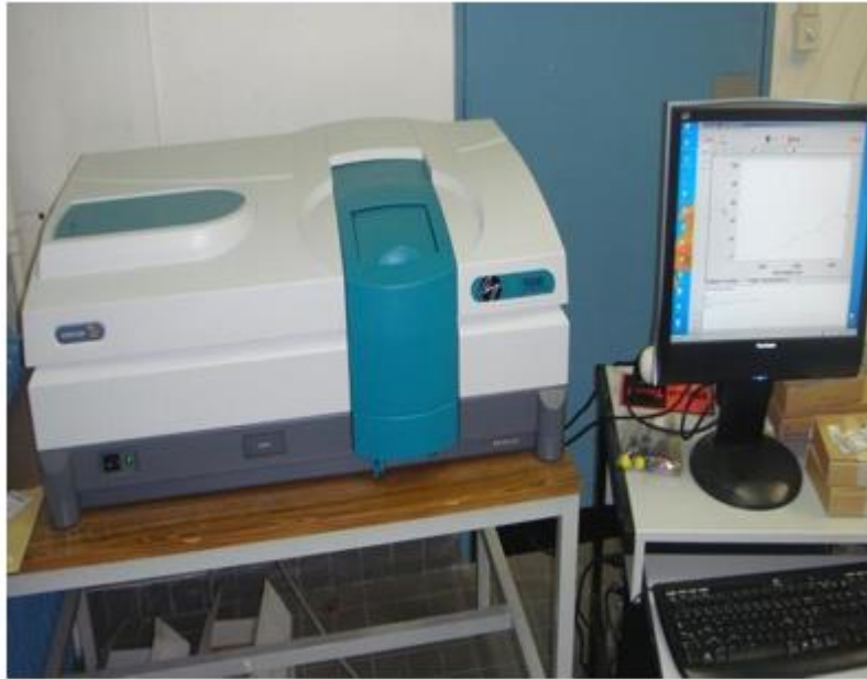
Figure. II.6 : Représentation schématique du spectrophotomètre UV-Visible [7].
