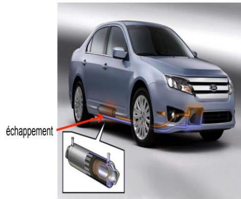
Figure II-14: Représentations de générateurs thermoélectriques équipant des prototypes de véhicule. [23]
