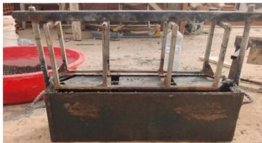
Figure III 5: Le béton Hourdis après 24h
