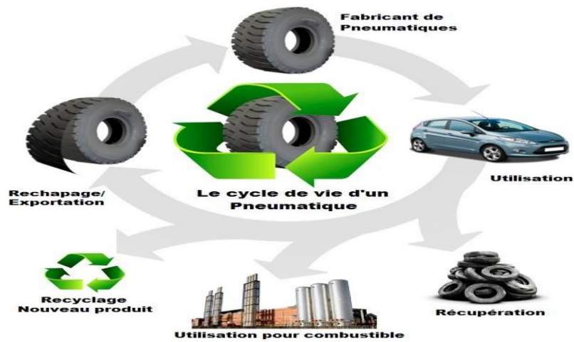
Figure II 13: Le cycle de vie d'un pneumatique
