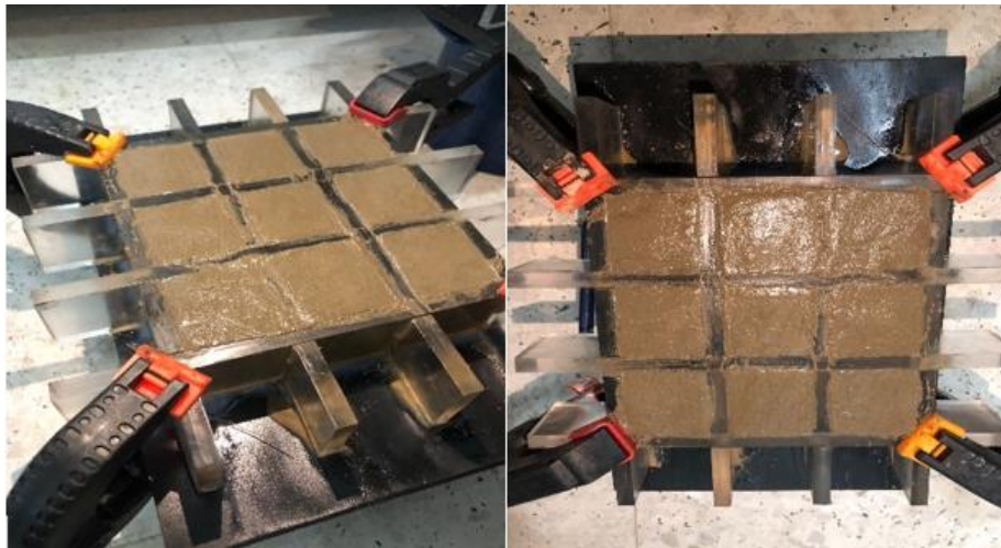
Figure 31: Coulage des mélanges
