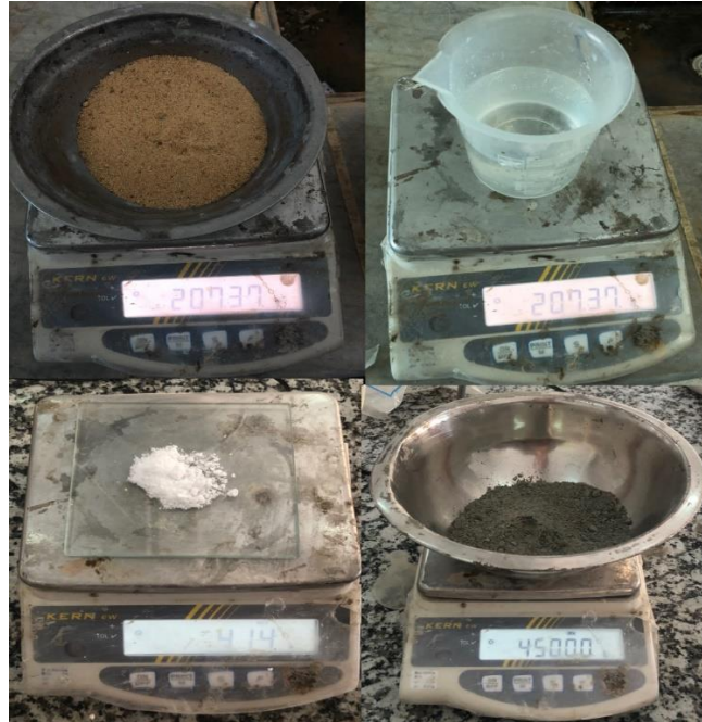
Figure 29: Les pesés de notre matériaux (sable, l'eau, \text{CaCl}_2 , ciment)
