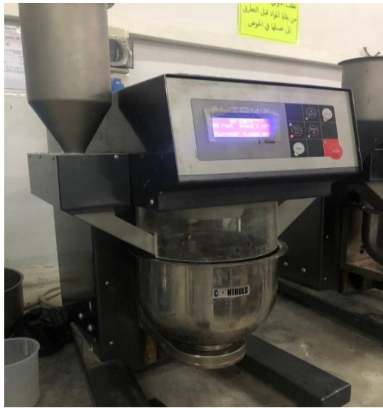
Figure 30: Malaxeur automatique de labo Génie Civil de l'université BBA
