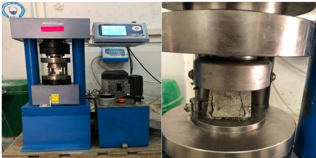
Figure 26: L'appareil de l'écrasement labo génie civil université de BBA
