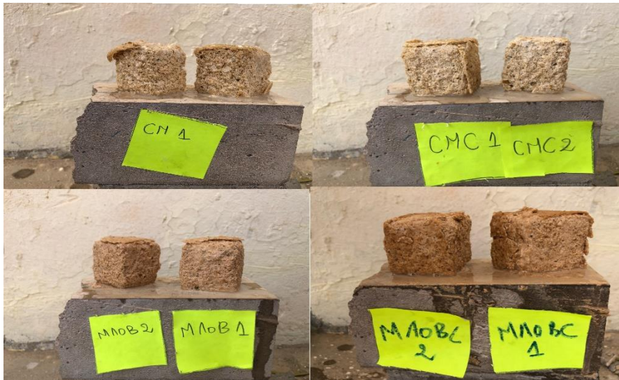
Figure 40 : La perte en poids des différents mélanges après éersion a la solution H2So4 après 90 jours
