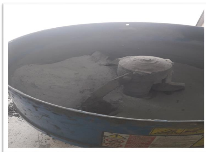
Figure IV.5 : malaxage sec des constituants.
