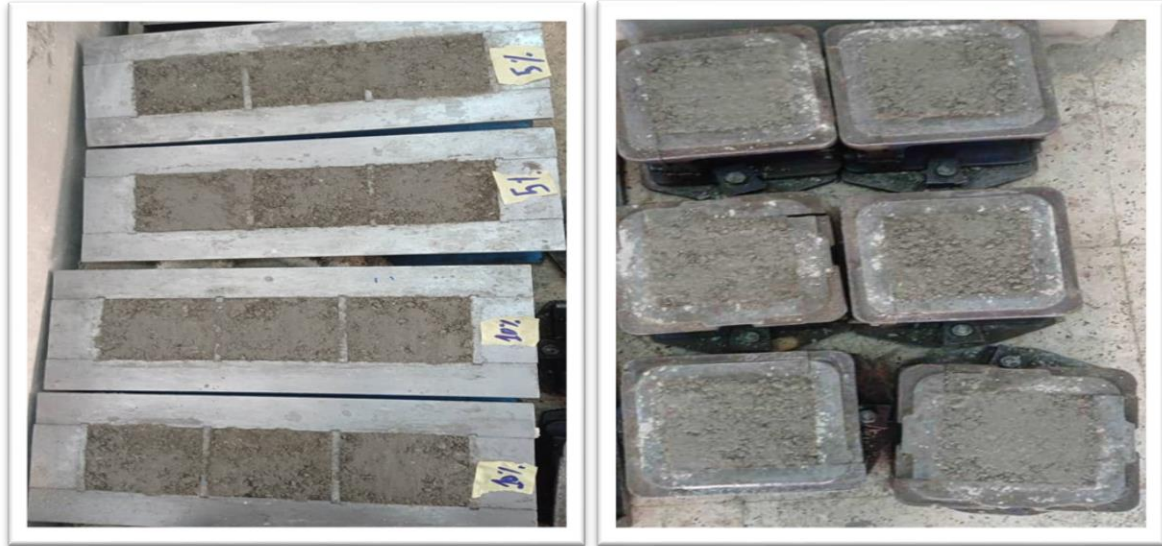
Figure IV.8 : éprouvettes ( 10*10*10 ) réalise pour l'essai de compression.
