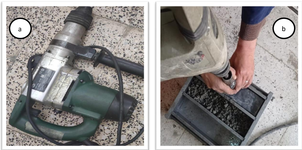
Figure IV.7 : a. Marteau piqueur utilisé pour le compactage ; b. compactage de l'éprouvette.
