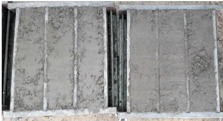
Figure IV.9 :éprouvettes ( 7*7*28 ) réalise pour l'essai de flexion et retrait.
