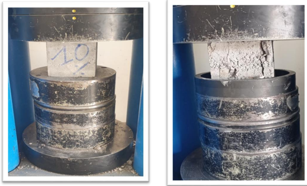
Figure IV.11 : Encrassement des éprouvettes de compression
